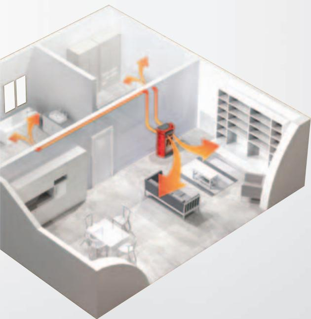
Le **stufe**, i **focolari** e **gli inserti** riscaldano con l'aria calda il locale di installazione e, in base al modello, più locali tramite canalizzazioni.
