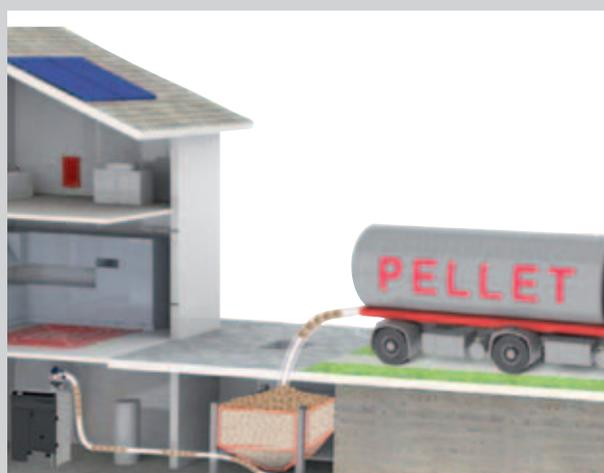
Esempio di approvvigionamento pellet tramite autobotte
