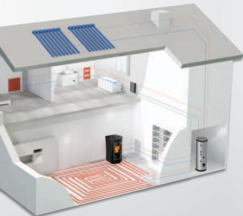
Le **termostufe**, i **termocamini** e le **caldaie** producono acqua calda per alimentare i **termosifoni** e i **pannelli radianti a pavimento** di tutta la casa.
