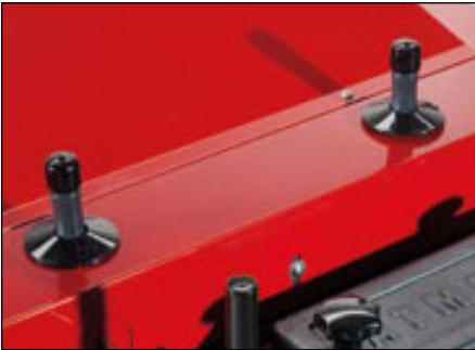
Dispositivo di sicurezza D.S.A. per l'abbattimento repentino della temperatura dell'acqua secondo le norme EN 303-5 previene eventuali surriscaldamenti assorbendo il calore del generatore quando il suo livello termico diventa troppo alto.
